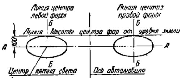
Рис. 13. Разметка экрана для регулировки света фар.
